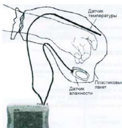
Рис. 17. Схема экспериментальной установки терморегуляции кожи
